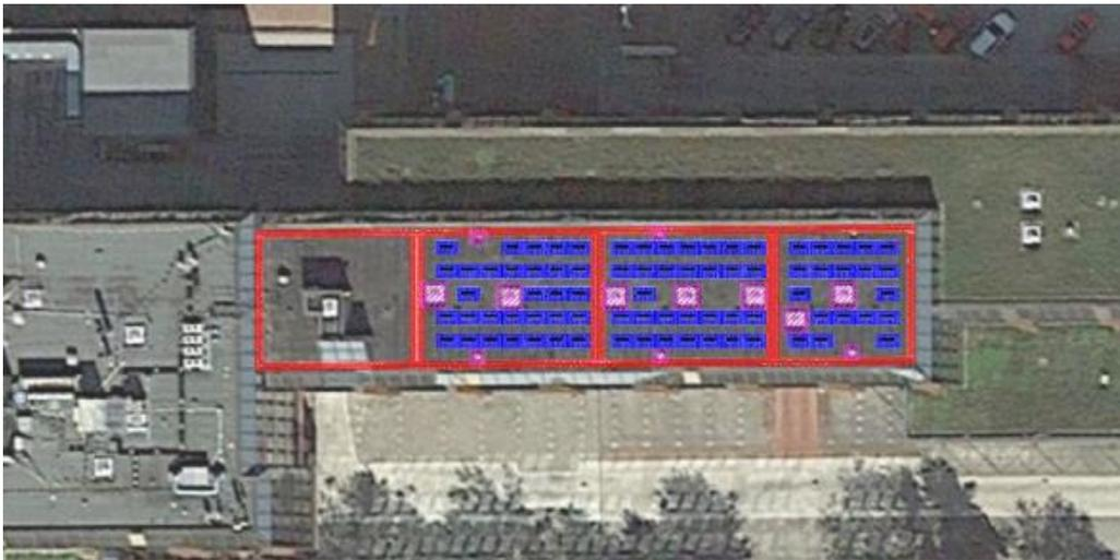
Nach Stellungnahme des Büros PHHT ist eine PV Anlage für das Dach geeignet. Nach erster Berechnung und Berücksichtigung der bekannten Hindernisse erreichen wir eine Gesamtleistung von ca. 32 kWp.
