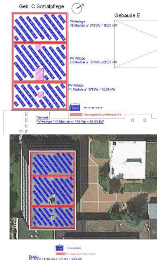
Nach Stellungnahme des Büros PHHT ist nur die Dachfläche Gebäudeteil C für eine PV-Anlage geeignet. Auf dem Dach wäre nach ersten Einschätzungen und Berechnungen eine PV Anlage von ca.61 kWp möglich.
