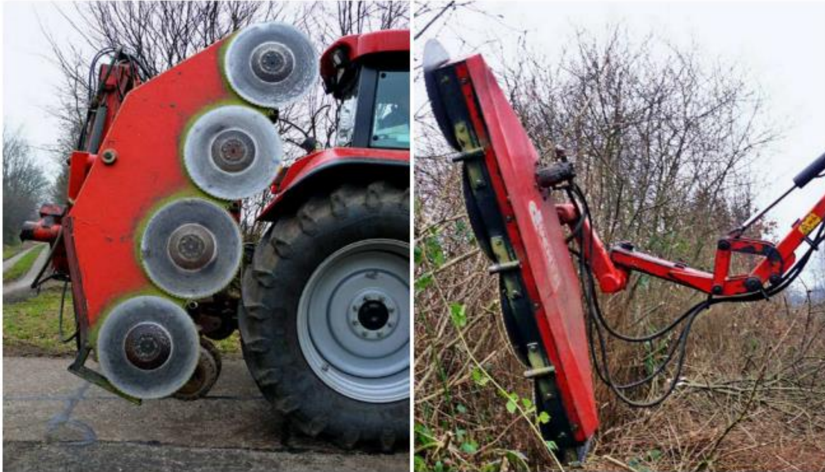
Abb. 6: An Auslegern angebrachte Lichtraum-Profilschneider ermöglichen einen schonenden, flexiblen Rückschnitt von Gehölzen.
