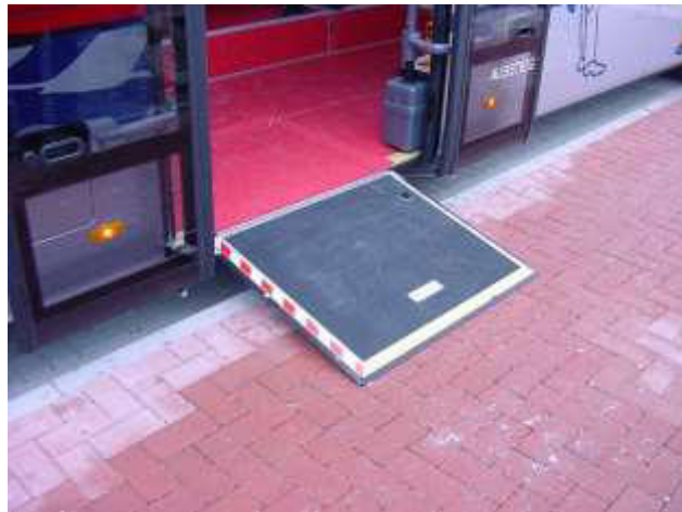
Abbildung: A - 16, Rampe zur Verbesserung eines barrierefreien Ein- und Ausstiegs
